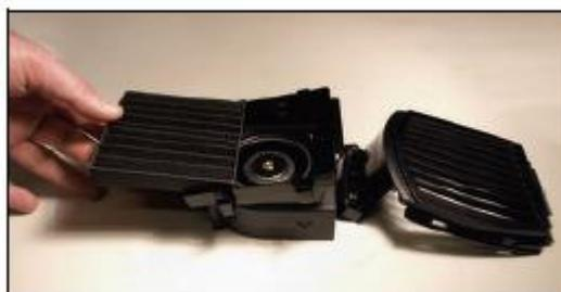
**Рисунок 15. Выравнивание воздушного фильтра головной части**
