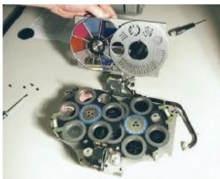
**Рисунок 26. Открытие модуля проекции**
